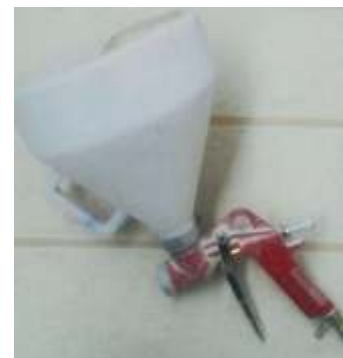
Рисунок 3 Пневмопистолет для нанесения второго слоя.
