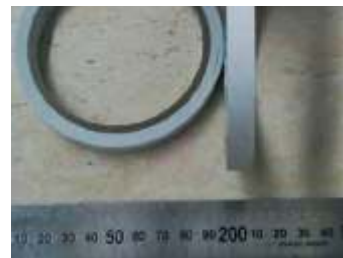
Рисунок 2 Усиленный скотч для выделения рустов и рисунков на поверхности.
