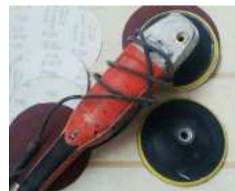
Рисунок 6 Шлифовальная машинка с регулятором оборотов и наждачные круги.
